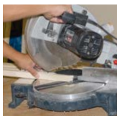
Glasleiste und FIXclip-Schiene zuschneiden
