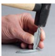
Sperrlaschen gegen- gleich ausbiegen (optional)
