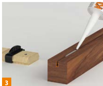
3 Nuten 4x12 mm fräsen und KNAPP®-Kleber PU+ in die Nut füllen oder auf den Lamellensteg auftragen.
