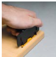
Einsetzen und mit Schablone positionieren
