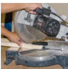
Glasleiste und FIXclip-Schiene zuschneiden
