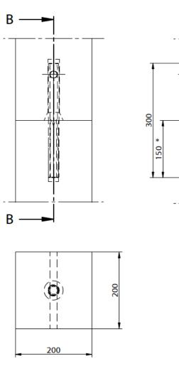
\* ... Mit der Eindrehtiefe kann die Festigkeit der Bauteilverspannung abgestimmt werden
