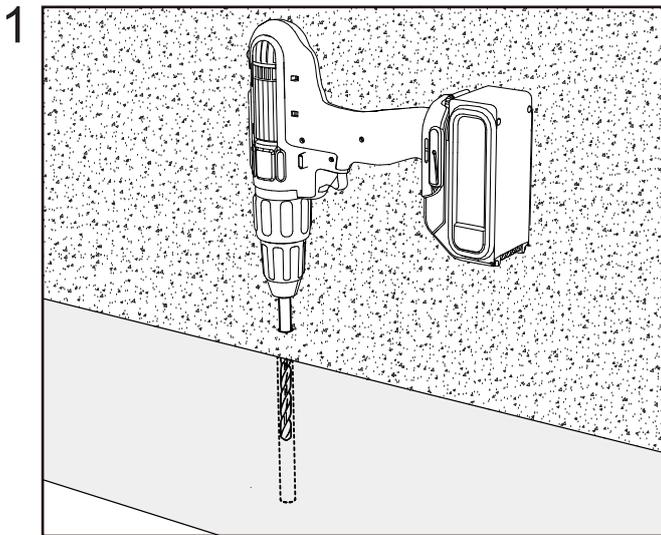
Bohren Sie das Loch in den Beton etwas größer als das Außengewinde des Stahlteils und beachten Sie dabei die erforderliche Tiefe.
