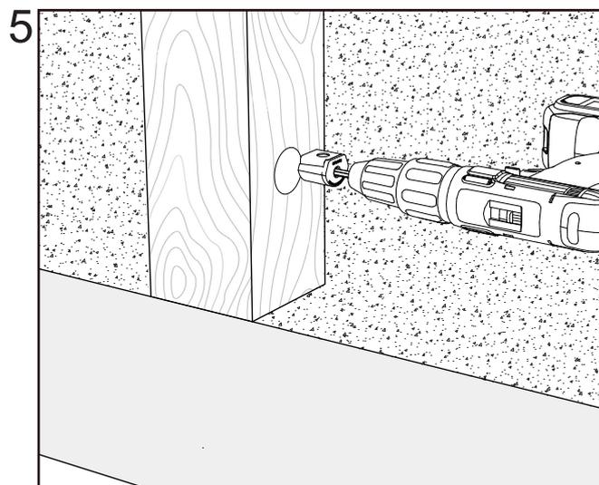
Montieren Sie den Pfosten mit dem Zipbolt Getriebegehäuse.
