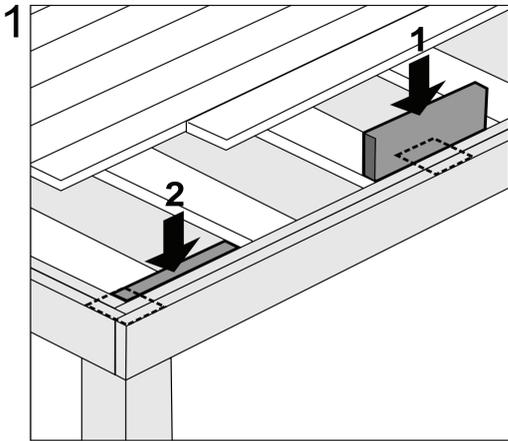
1. Fügen Sie bei Bedarf zusätzliche Blockierungen hinzu, um alle vier Schrauben und die mittlere Lag-Schraube aufzunehmen.
