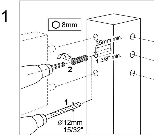
Nachdem Sie das Mittelloch für die Einschraubmutter markiert haben, bohren Sie ein senkrechtes Loch mit einem Durchmesser von 12 mm. Bei Harthölzern kann das Loch größer sein. In diesem Fall empfiehlt sich Wachs. Verwenden Sie einen 8-mm-Inbusschlüssel, um die Einschraubmutter einzudrehen.
