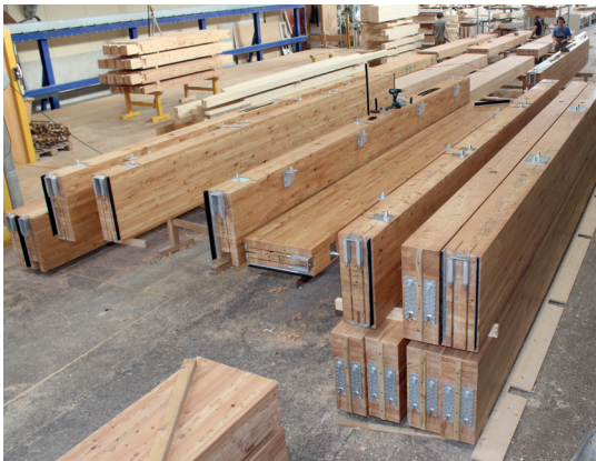
Neben RICON® S Verbindern für die Konstruktion kamen WALCO® V Verbinder für die Faassade zum Einsatz.
