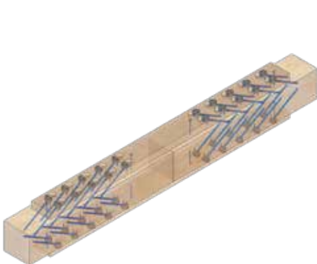
T-JOINT D35 W30 befestigte Laubholzlaschen von BSH-Zugstößen
