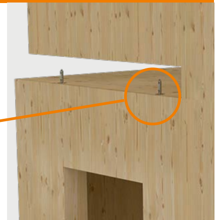
Exemple : Jonction mur-mur avec WALCO BOLT B130
