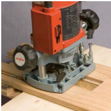
Usinage manuel avec gabarit et défonceuse portable
