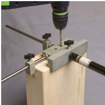
Pré-perçage poutre secondaire
