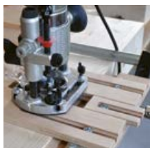
Usinage avec gabarit
