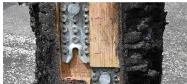
Résultat d'essai au feu en condition de charge après 90 minutes. La section de bois est carbonisée tout autour du connecteur RICON S®, elle a garanti son intégrité et ses capacités de résistance à l'effort exercé.
