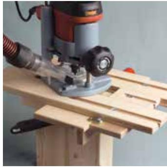
1) Usinage manuel avec gabarit et défonceuse portative.
