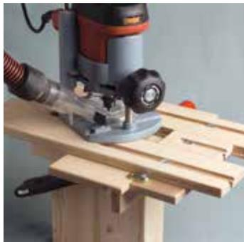
1) Usinage manuel avec gabarit et défonceuse portable.
